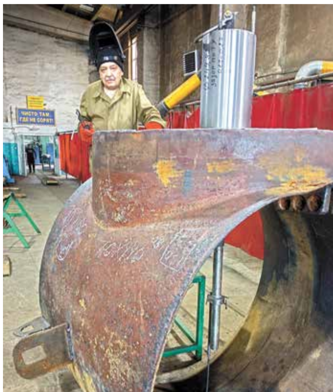
Ашмагамбетов Р.А. Установка ступицы насадки теплохода проекта 1741А
