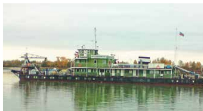
Землесос «Иртышский -727» на разработке переката
