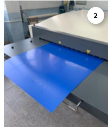
На этом агрегате выполняют копирующие процессы. Скрытое изображение наносится на биметаллическую пластину, и после химической обработки получается печатная форма.
