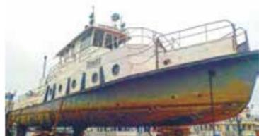
В настоящий момент на теплоходе ведется проварка сварных швов на сменных участках обшивки, закончена переборка главного двигателя ЯМЗ-238. В жилых помещениях идут плотницкие работы: закончена отделка фанерой, ожидаются поставки судового пластика для дальнейшего завершения отделочных работ.
