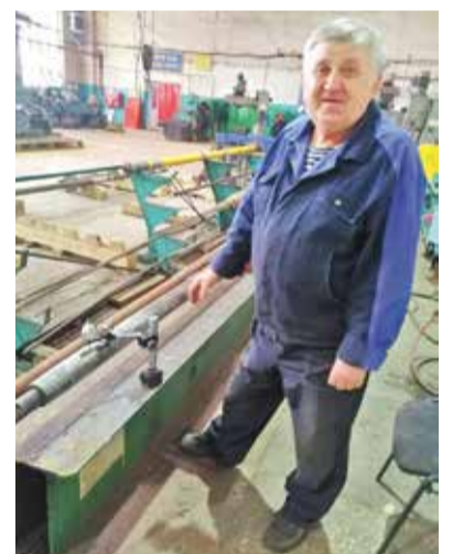
И.П. Станчак. Правка гребного вала теплохода проекта Р-376
