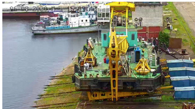
КЭТП-9, плавкран КПЛ 5/30 ООО «Сибарматура», слипование для дефектации судна
