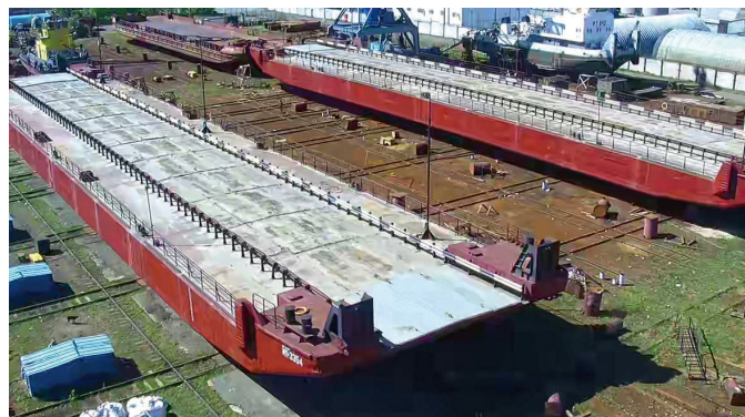
Баржи МП-3353 и МП-3353, секции наплавного моста ООО «Речной порт» (г. Нефтеюганск) после дефектации, мелкого ремонта, покраски
