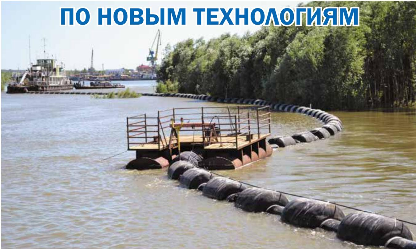
Испытания нового резино-тканевого грунтопровода в ФБУ «Администрация «Обь-Иртышводпуть» проведены успешно. *Подробнее на с. 3*
