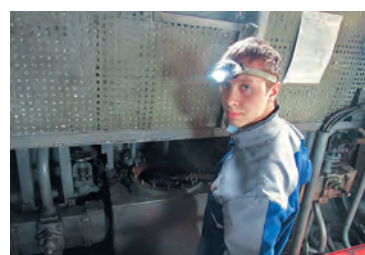
Моторист-рулевой А.Ю. Комаров зачищает ящик забортной воды на т/х «Киви»
