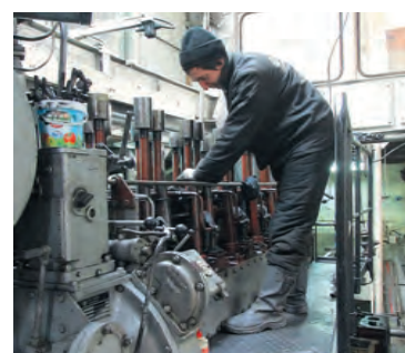
Моторист-матрос И.М. Захаров на ремонте левого ходового двигателя з/с «Надым»
