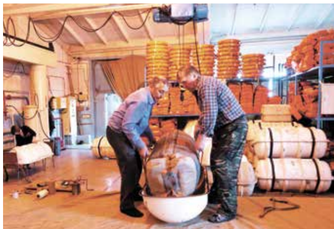
Заключительный этап: слесари-ремонтники Виктор Иванович Пронин и Сергей Викторович Семёнов укладывают испытанный и освидетельствованный плот в контейнер
