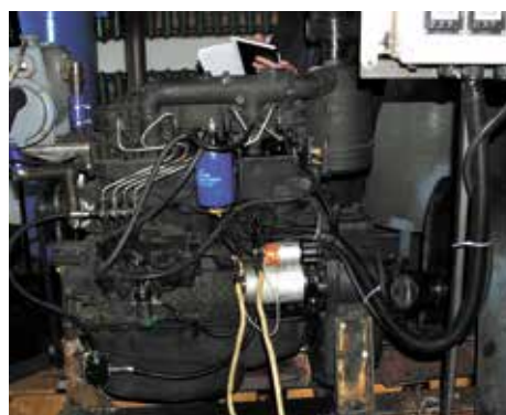
Двигатель Д-246.1 после агрегатирования на испытательно-обкаточном стенде
