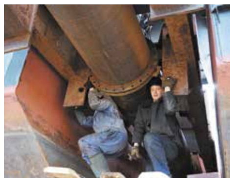
Моторист-матрос А. Макаров и П помощник командира С.Н. Лосилкин «Иртышского-1020» меняют часть всасывающего трубопровода на своем землесосе
