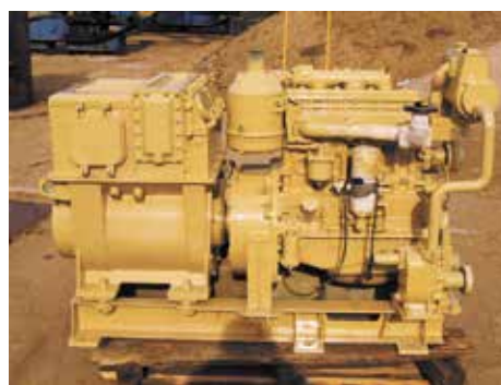
Двигатель Д-246.1 перед установкой в корпус судна «Владимир Теренин»
