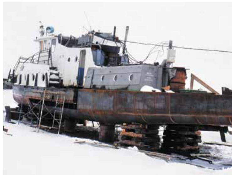
Замена обшивки корпуса на т/х «Улар»
